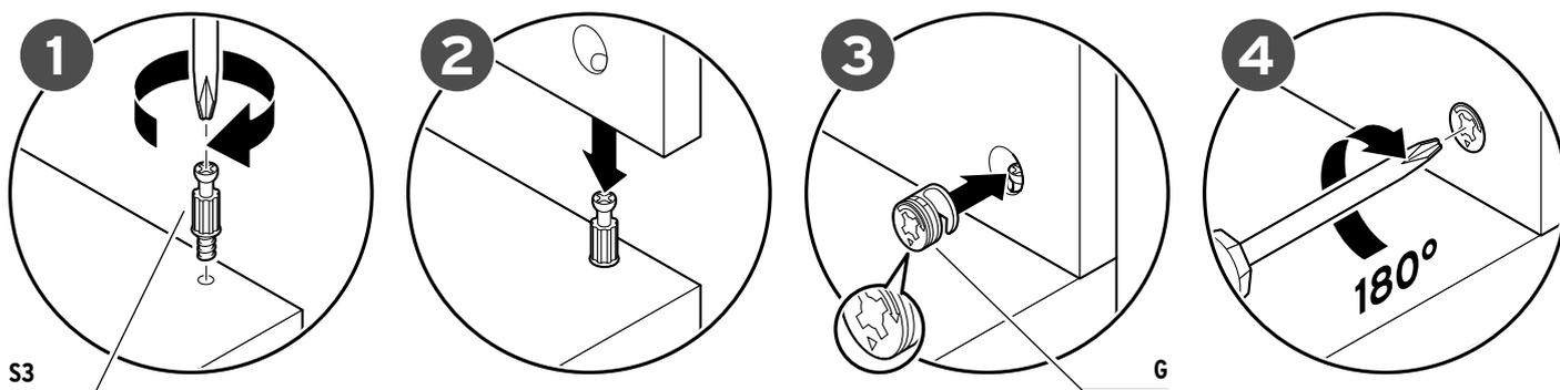
Aufbau | Montage | Montaggio | Assembly | Montáž | Montaž | Montáž | Összeszerelés | Kurulum
